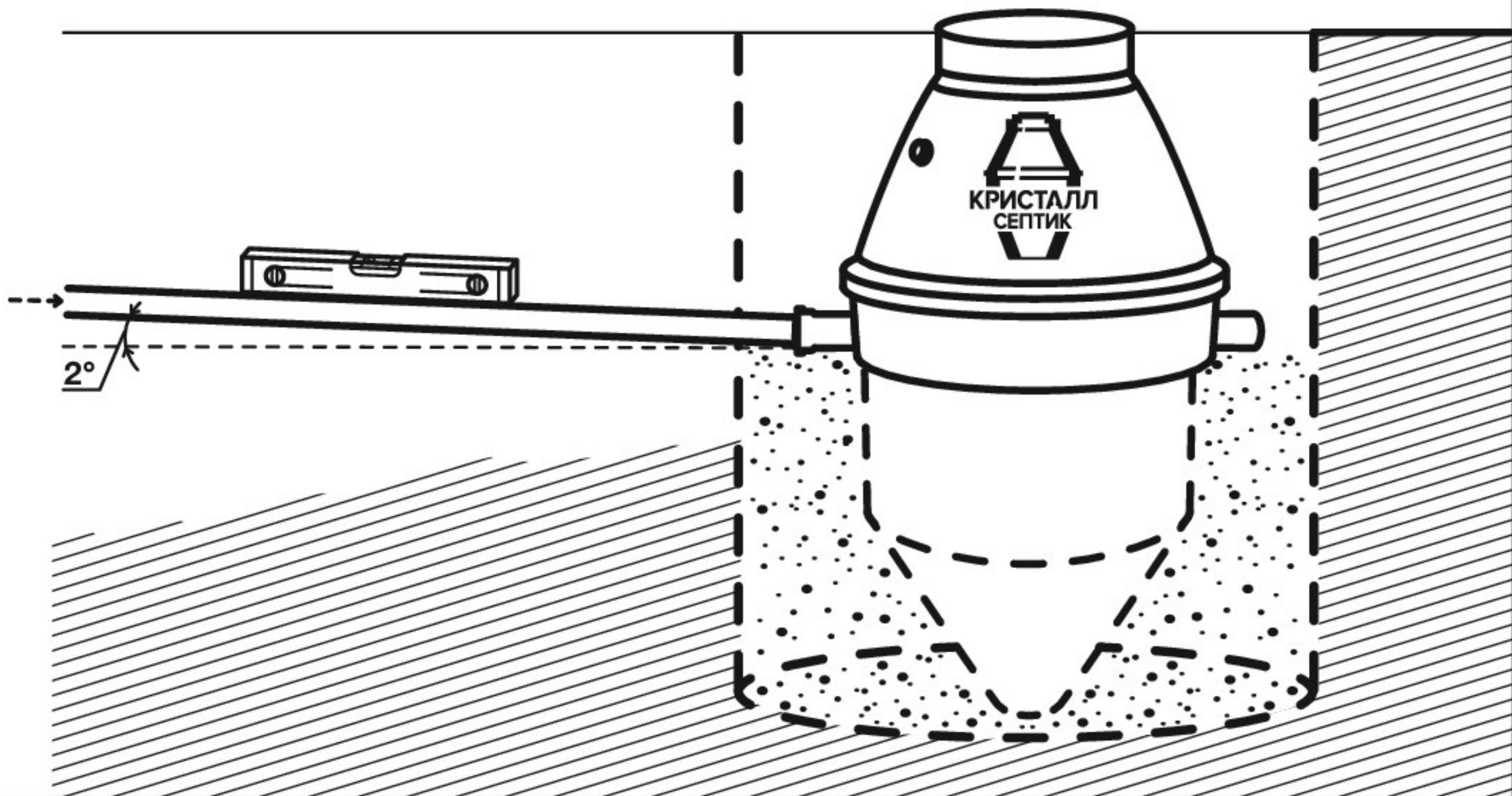
**9****ПОДКЛЮЧЕНИЕ САМОТЕЧНОГО СЛИВА ОЧИЩЕННОЙ ВОДЫ**
